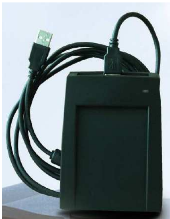
Рис. 1. Китайский 125KHz Proximity Card Reader CR-10E с USB интерфейсом.
